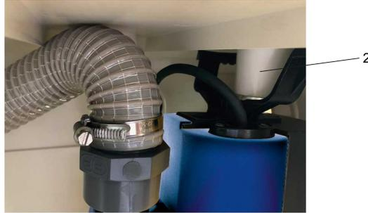
**Abb. 17:** Korrekte Einbaulage des Deckels und des Pumpenaggregats
